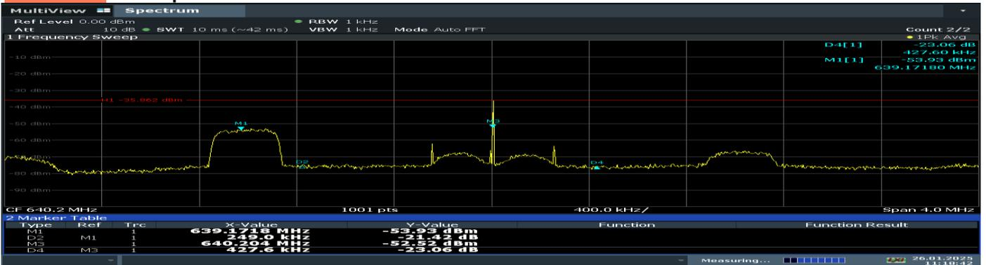
**100 KHz** Avec une RBW de 100 KHz La mesure affiche des signaux de niveaux très proches
